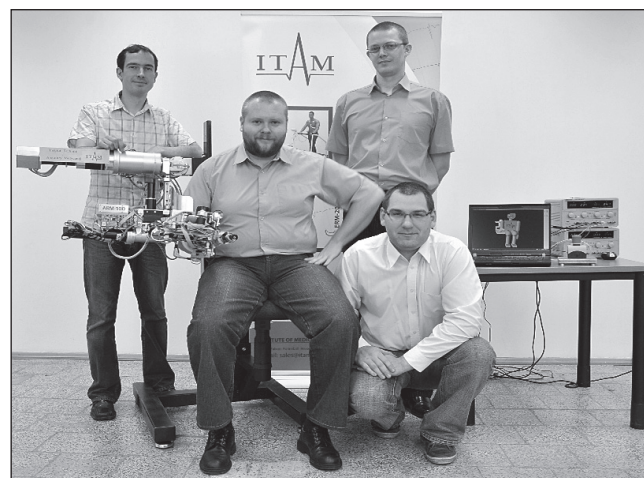
Fot. 1 Prototyp robota rehabilitacyjnego ARM-100 i zespół jego konstruktorów z ITAM w Zabrze, (od lewej) konstruktor elektronik Andrzej Michnik, konstruktorzy mechanicy: Michał Bachorz, Grzegorz Nowak, Łukasz Juszyński
